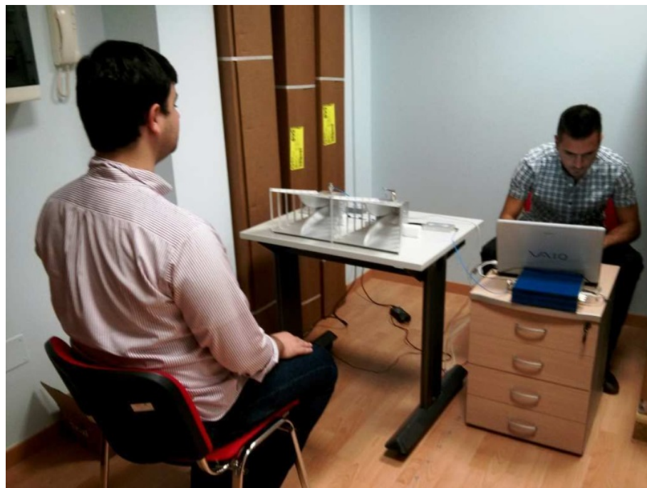
Fig.4.1 Esperimenti di monitoraggio del respiro mediante il sistema bioradar sviluppato presso l'IREA.
